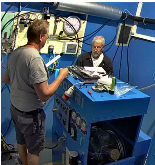
**Störung:** Defekt der 3. Stufe des Kompressors (Kolben/Zylinder) mit einer Ausfallzeit vom 06. Juni - 13. Juli 2022
